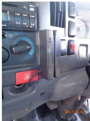
รูปที่ 3.30 การติดตั้งระบบ Global Positioning System (GPS) ที่รถขนส่งสารเคมี
