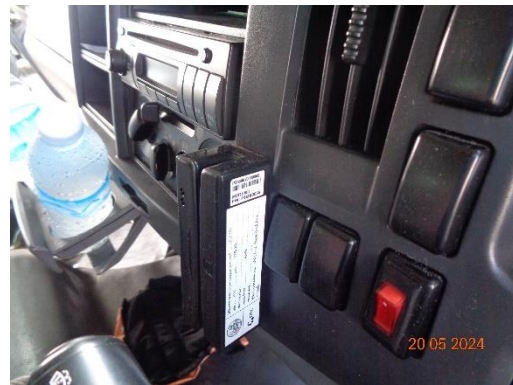
รูปที่ 3.30 การติดตั้งระบบ Global Positioning System (GPS) ที่รถขนส่งสารเคมี
