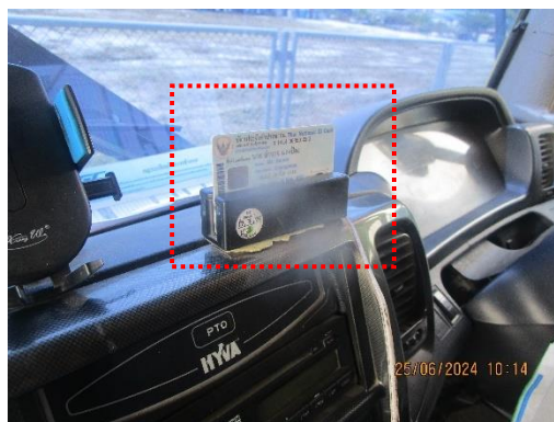
รูปที่ 3.35 การติดตั้งระบบ Global Positioning System (GPS) ที่รถขนส่งกากของเสียอุตสาหกรรม
